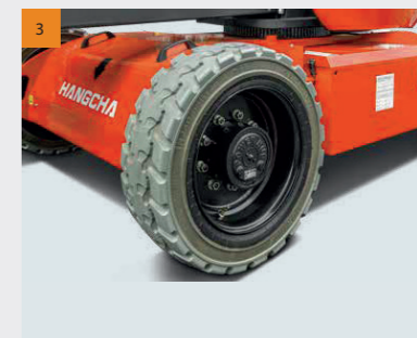
3 Pneus: pneus superelásticos com bom desempenho off-road
