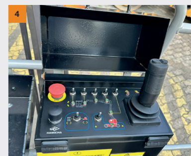
4 Caixa de controle da cesta: cada ação do dispositivo pode ser controlada através da caixa de controle para chegar rapidamente à área de trabalho, e o controle é simples e de fácil compreensão
