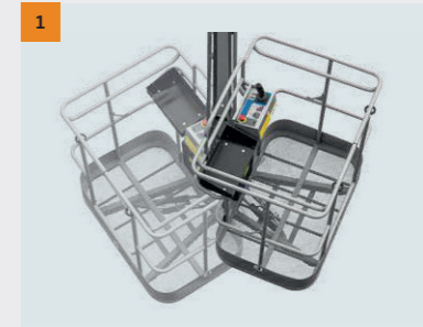
1 Cesta: pode ser girada para a esquerda e para a direita em um ângulo de 140°
