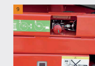
Válvula de abaixamento manual: Quando o sistema de operação falhar ou a energia da bateria estiver muito baixa para permitir que a plataforma desça, podemos usar esta válvula para abaixar a máquina
