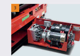
Sistema hidráulico e elétrico
