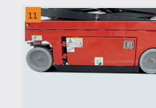
Válvula de abaixamento manual: Quando o sistema de operação falhar ou a energia da bateria estiver muito baixa para permitir que a plataforma desça, podemos usar esta válvula para abaixar a máquina
