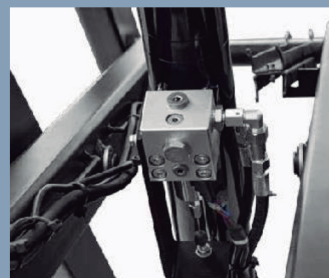
Válvula à prova de explosão, para evitar que a máquina caia quando há vazamento do tubo de óleo
