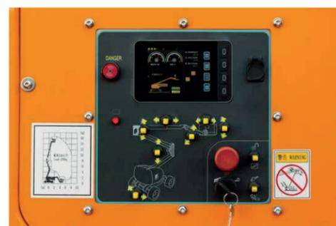
Ele possui um controle da base e um sistema de controle de plataforma que usam chaves de comutação para a conversão. O controle do cesto é usado para travar o controle da base. Os dois sistemas são protegidos por blindagens.
