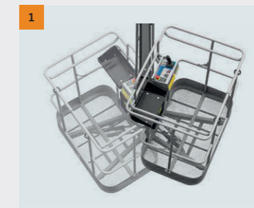
1 Cesta: pode ser girada para a esquerda e para a direita em um ângulo de 140°
