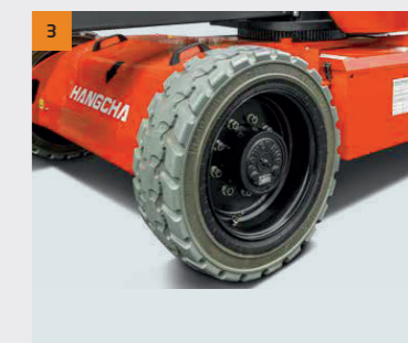
3 Pneus: pneus superelásticos com bom desempenho off-road
