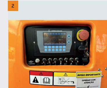
2 Caixa de controle da base: a caixa de controle pode ser usada para controlar cada ação do dispositivo, de fácil compreensão
