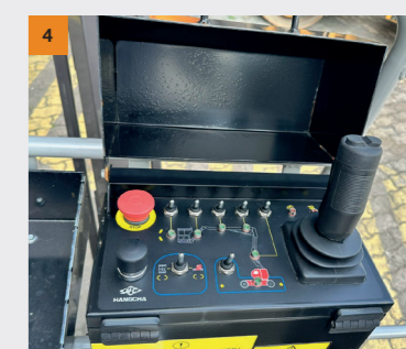
4 Caixa de controle da cesta: cada ação do dispositivo pode ser controlada através da caixa de controle para chegar rapidamente à área de trabalho, e o controle é simples e de fácil compreensão
