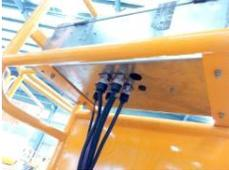
4. Desconecte o cabo existente na parte inferior da caixa de controle.
