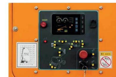
Ele possui um controle da base e um sistema de controle de plataforma que usam chaves de comutação para a conversão. O controle do cesto é usado para travar o controle da base. Os dois sistemas são integrados e de utilização simultânea.
